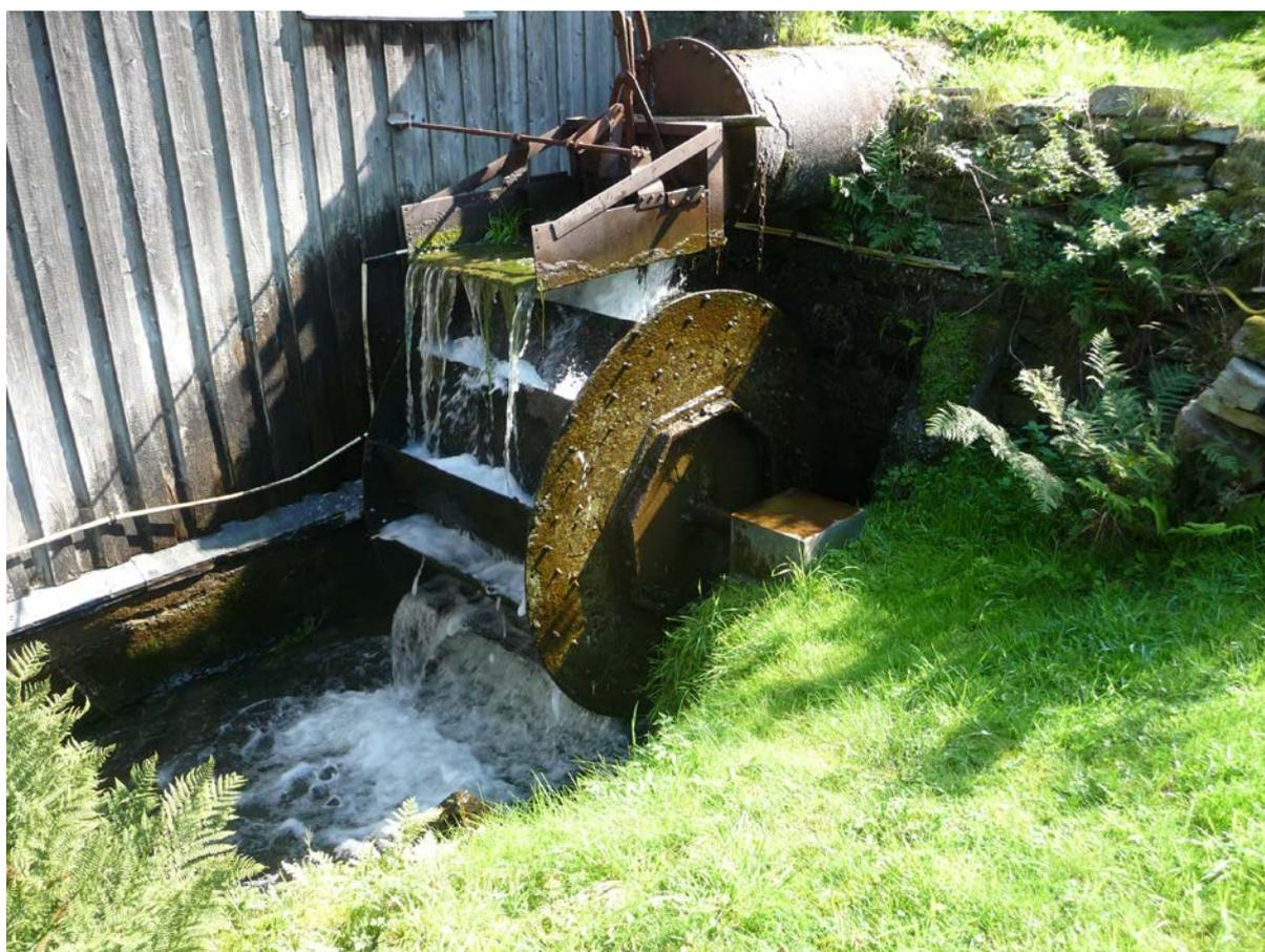
*Bild 2-5: Oberschlächtiges Wasserrad der Löhr-Mühle an der Ennepe, Foto: Märkischer Kreis*
